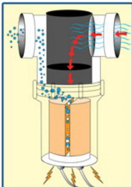
Микропроцессор блока управления контролирует количество поступающих в воду ионов, а регулируемый трансформатор превращает переменный 115 или 230 В ток от сети в постоянный низковольтный ток. Чем выше заряд, тем больше выделяется ионов.
